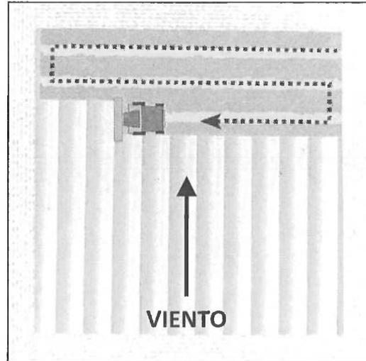
**¡MUY IMPORTANTE!** En terrenos irregulares, pedregosos y con pendiente reducir la velocidad de avance y elevar la plataforma y altura de corte.
